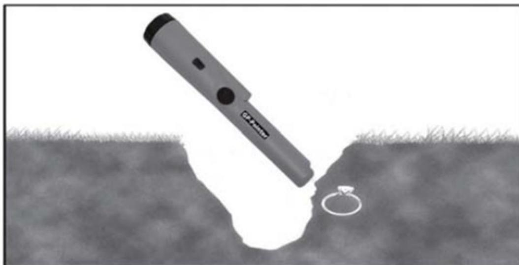
Если вы не получите звуковой сигнал о найденном объекте просканировав вырытую почву и/или почву вокруг отверстия, то объект, скорее всего, находится глубже в земле или вырытой почве - за пределами диапазона определения. В таком случае используйте ваш металлоискатель для поиска объектов в земле еще раз. С его помощью проверьте почву и подтвердите местонахождение объекта.
