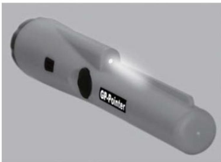
**Крышка батарейного отсека** - эта крышка закрывает отсек с батареей и позволяет быстро и легко менять девятивольтовую батарею металлоискателя. Никаких инструментов для этого не требуется. Просто поверните крышку батарейного отсека против часовой стрелки, чтобы ее снять, и по часовой стрелке, чтобы ее закрыть. Контакты батареи несимметричны во избежание неправильной установки батареи.
